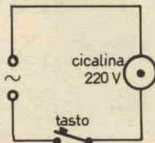
E' ovviamente il più semplice schema realizzabile dato che non occorrono neppure batterie di alimentazione.
